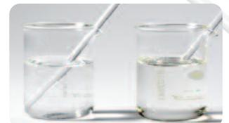
Beim rechten Glas entspricht der Lichtbrechungsindex des Monomers demjenigen des Füllers. Beim linken Glas nicht.
