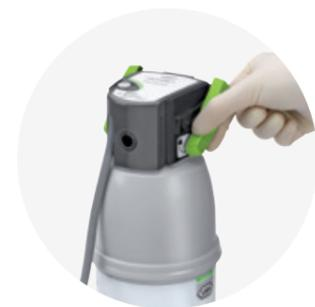
**1.** Um eine verbrauchte Filterkartusche zu ersetzen, öffnen Sie den Verriegelungsgriff.
