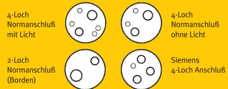
Für alle Turbinenschlauch-Anschlüsse bietet KaVo die passende MULTiflex®-Kupplung
