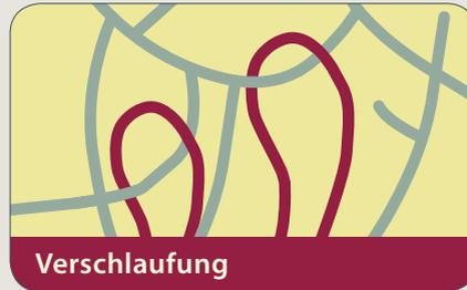
Bei der Polymerisation der Monomere bilden sich Polymerketten, die in der Harzmatrix verankert sind.
