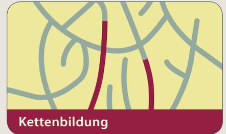
In der Harzmatrix enthaltene Doppelbindungen bilden bei der Polymerisation mit Monomeren Ketten.
